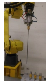
自動換爪取放螺絲與電池組自動氣密檢測。
